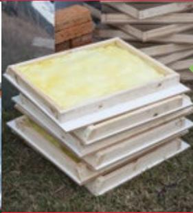
Presentamos y después ensamblamos las cinco partes que forman la caja del horno (el fondo, las dos paredes laterales cortadas en ángulos de 30° la pared frontal y el piso).
